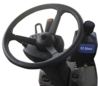
Рисунок 6.3 – Подруливающее устройство EZ-Steer
